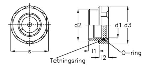
d1 = 14 d2 = G1/2 d3 = 26 l1 = 8.5 l2 = 7.5 Max pressure = -Max vacuum mbar = s = 23
